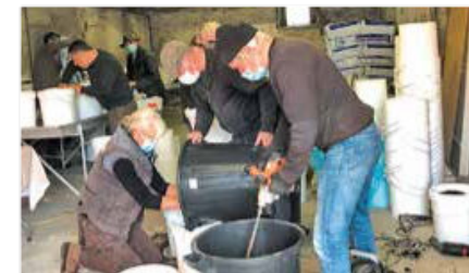
Mélange des composants à la perceuse avec un agitateur de peinture.
